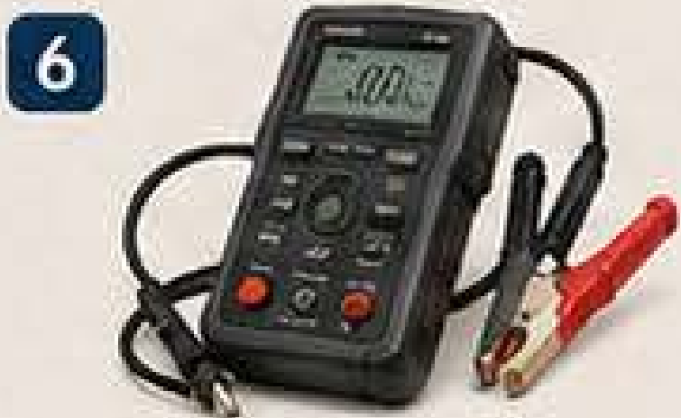
جهاز فحص البطاريات Battery Tester متوافق مع NiCad و Lithium قياس سعة وقوتية
